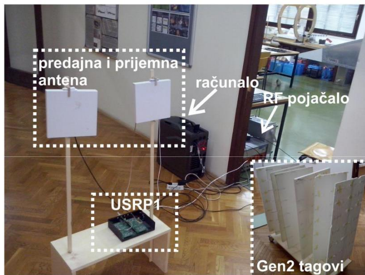
Slika 12.6. Hardver korišten u mjerenjima
